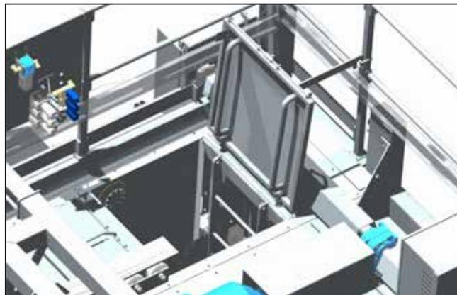
Cuando está en uso, la trampilla con asas integradas queda bloqueada en posición vertical. Cuando no está en uso, la escalerilla queda fijada al techo de la Backloader.
