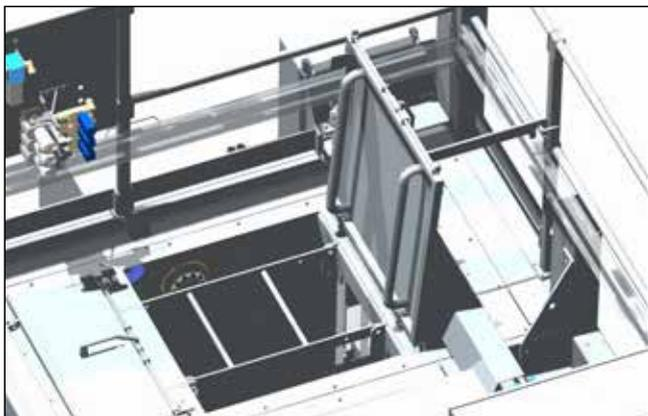
El techo de la Backloader está equipado con cáncamos que van centrados sobre las guías de cadena para facilitar el mantenimiento de la cadena.
