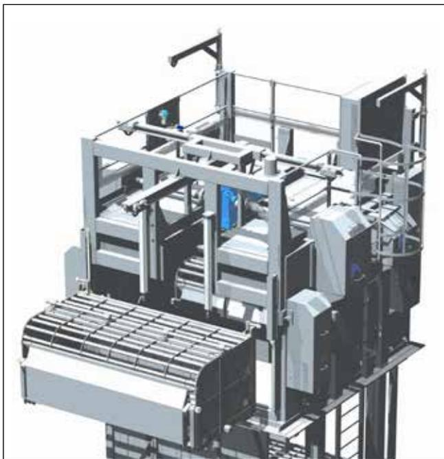
Las góndolas y el motor principal se pueden extraer fácilmente usando un simple travesaño. El travesaño también se usa para quitar la puerta elevable del volcador y cubierta frontal principal. No es necesario quitar la mesa de rodillos y sección frontal inferior con la plancha de volcado. Con el volcado eléctrico no es necesario quitar las unidades volcadoras.
