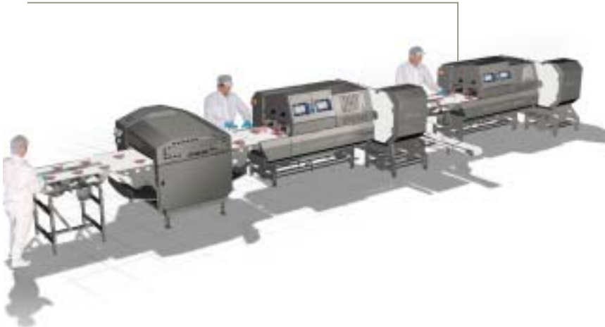
Platino 800 og IPM III LaserEye strimlaskurðarlína fyrir kjúklingabringur
