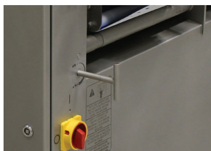
La manija simple en forma de T permite ajustes ilimitados para un correcto despielado
