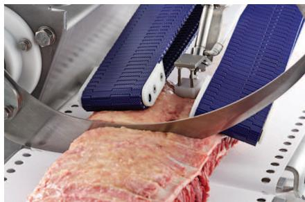
Producto soportado por el soporte del producto y la horquilla de retención durante el corte
