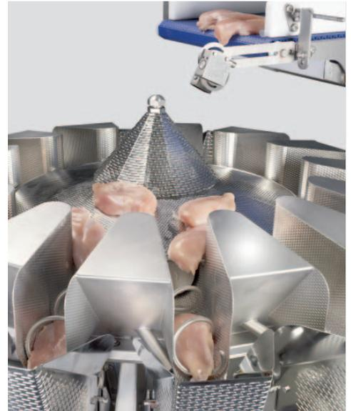
Con due lavori, la pesatrice multitesta ha improvvisamente più opzioni a sua disposizione ed è in grado di fare molto meglio uso del prodotto in entrata. Ogni volta che nuovi prodotti giungono alle tramogge di pesatura, la pesatrice multitesta calcola tutte le possibili combinazioni di prodotto e confronta i risultati con i due pesi di confezione desiderati. Quindi viene scelta l'opzione migliore. La partita verrà creata e depositata nel vassoio corretto.
