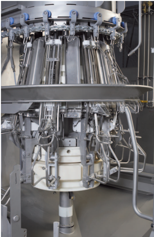
Máquina cortadora de cloacas/abridora (VOC-8)
