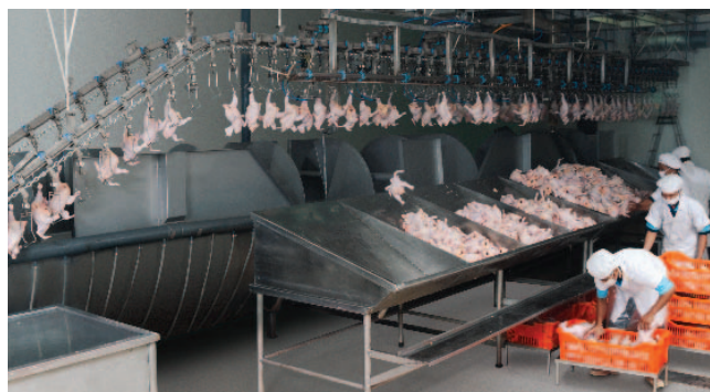
Линия распределения со сборными бункерами для сортировки по массе
