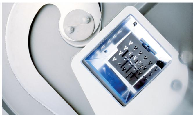
Parallele Scheiben und höchste Ausbeute werden durch einen perfekten Griff des Produktes, auch bei knochenhaltigen Produkten, möglich. Ein Blick in den Messerkasten zeigt ein dünnes Messer für einen exakten Schnitt.
