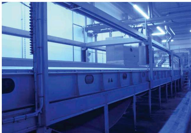
La utilización de dióxido de carbono en múltiples fases, como se aplica en nuestros sistemas CAS multifase, como el CAS SmoothFlow en línea recta, se menciona específicamente en la lista de métodos de aturdir aceptados y no necesita requisitos adicionales.
