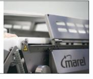
Bandheber gewährleisten einen optimalen Zugang während der Reinigung.
