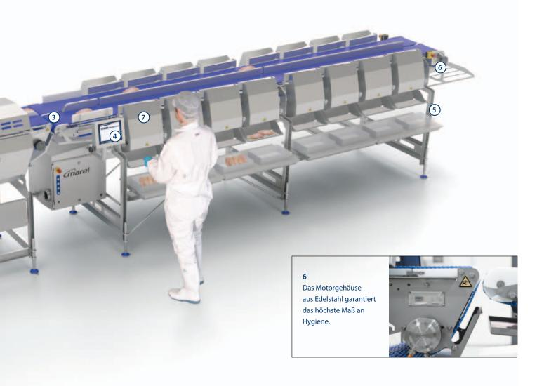
5 Die offene Rahmenkonstruktion ermöglicht eine maximale Reinigungsfähigkeit und einen einfachen Zugang.
