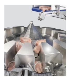
Die Mehrkopfwaage hat bei zwei Aufträgen plötzlich mehr Optionen zur Verfügung und kann die zugeführten Produkte besser nutzen. Jedes Mal, wenn neue Produkte den Wiegetrichtern zugeführt werden, berechnet die Mehrkopfwaage alle Optionen für eine Kombination der verfügbaren Produkte und passt die Ergebnisse mit den zwei Zielgewichten an. Anschließend wird die beste Option ausgewählt. Die Charge wird erstellt und in die korrekte Schale freigegeben.
