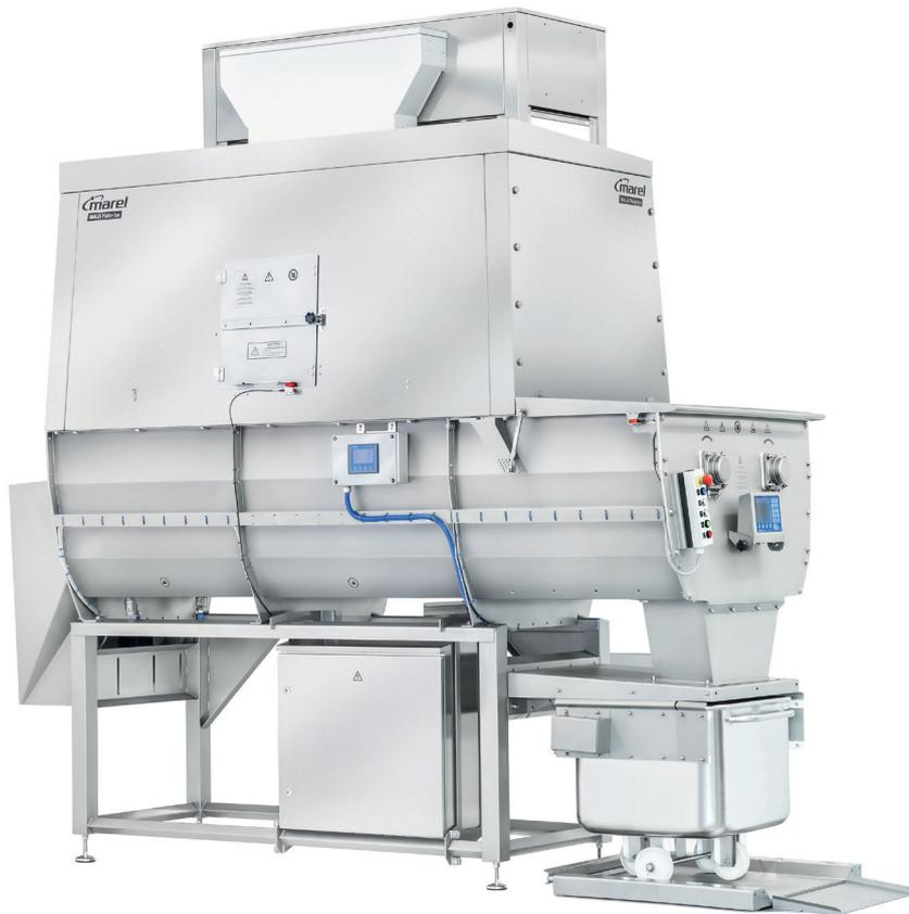
Das IXT Silo wird mit einem MAJA-Scherbeneiserzeuger kombiniert und ermöglicht die wirtschaftliche Lagerung von Scherbeneis in großen Mengen. Das Silo kann in
