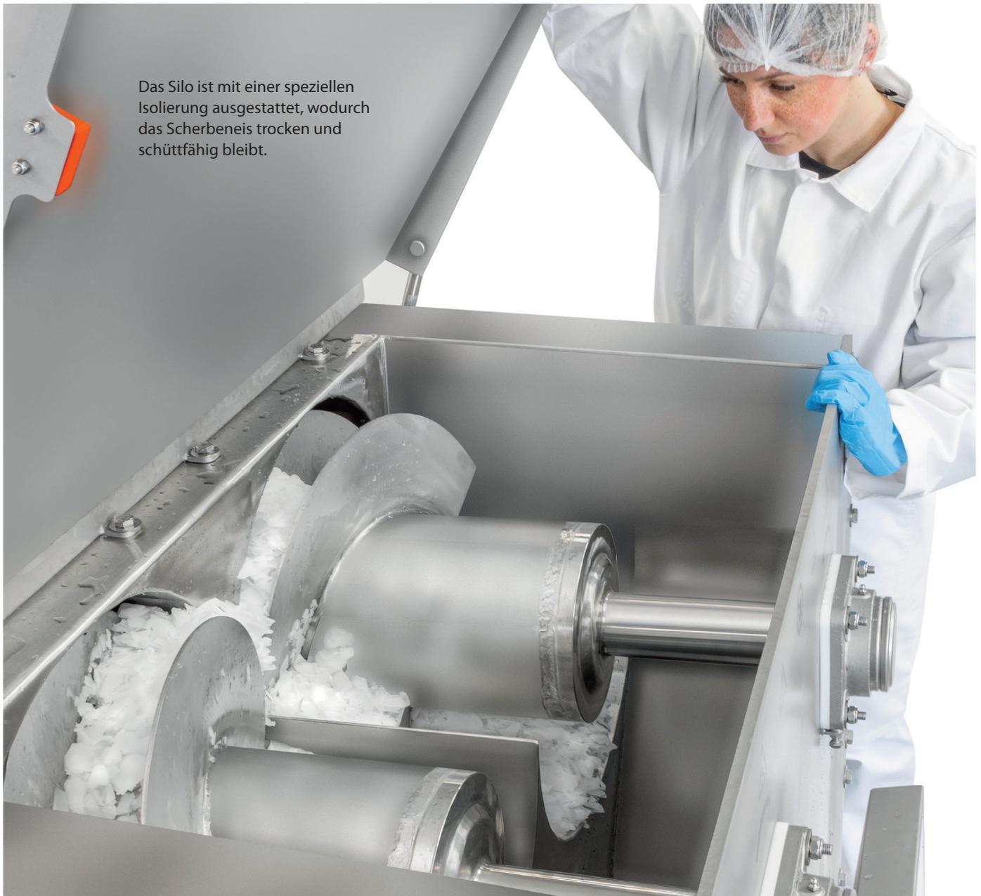
Das Silo ist mit einer speziellen Isolierung ausgestattet, wodurch das Scherbeneis trocken und schüttfähig bleibt.
