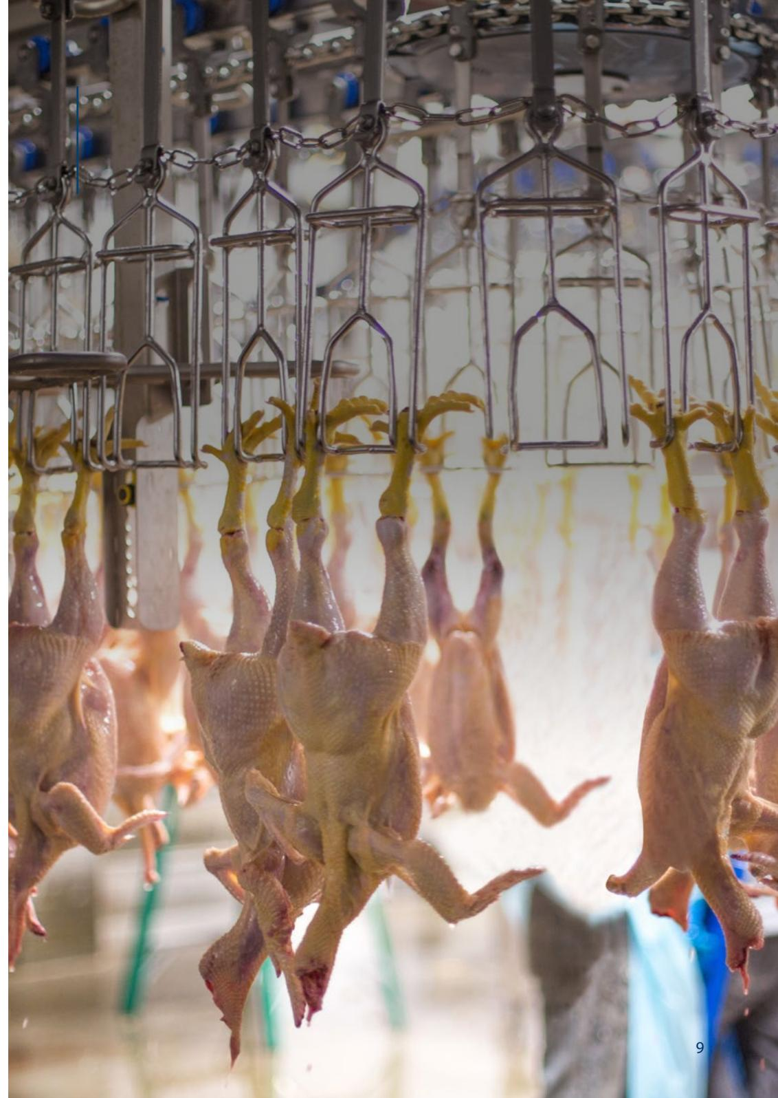
Les crochets vides sont également enregistrés. Cela permet aux transformateurs de voir tout écart dans le processus d'accrochage, de voir si des volailles ont pu tomber plus loin dans la ligne après l'accrochage initial, ainsi que de laisser un peu d'espace entre les lots, de sorte que le processus du lot et le changement puissent être facilement identifiés.
