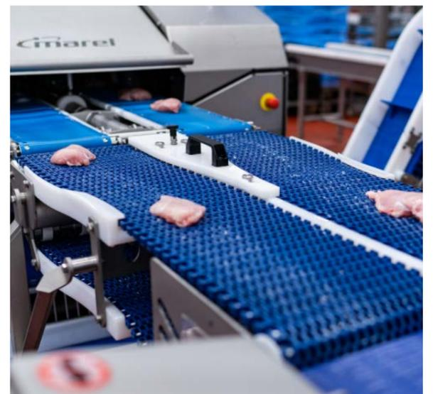
La creación manual de envases de peso fijo requiere mucho trabajo y puede dar lugar a unas mermas inaceptablemente altas, dos buenas razones para la automatización. Vodnanska Drubez cuenta ahora con un “Robot con cuchillo” para los envases de filetes frescos de peso fijo y una báscula multicabezal MHW de Marel para los envases de peso fijo de porciones frescas o congeladas con y sin hueso.
