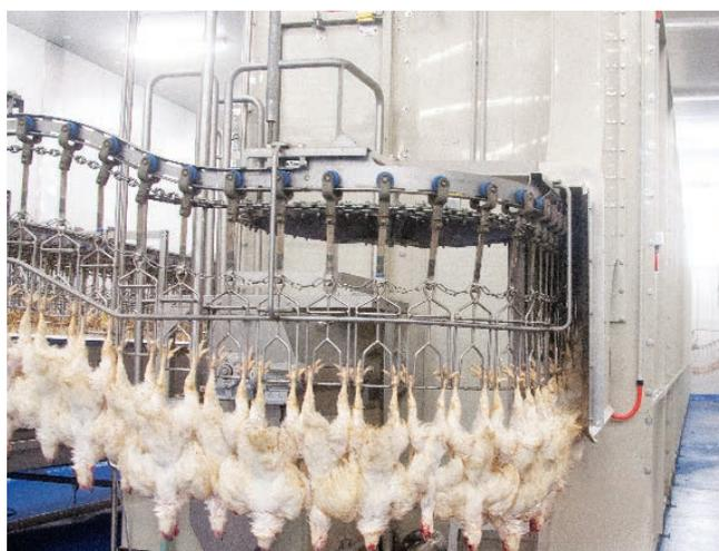
Nossos sistemas de escaldagem apresentam uma limpeza e manutenção fáceis e utilizam um mínimo de energia. A solução inovadora AeroScalder utiliza 75% menos água e 50% menos energia. Trata-se da referência mais recente de sistemas de escaldagem de qualidade máxima e foi desenvolvida com uma preocupação muito séria em relação a questões ambientais.
