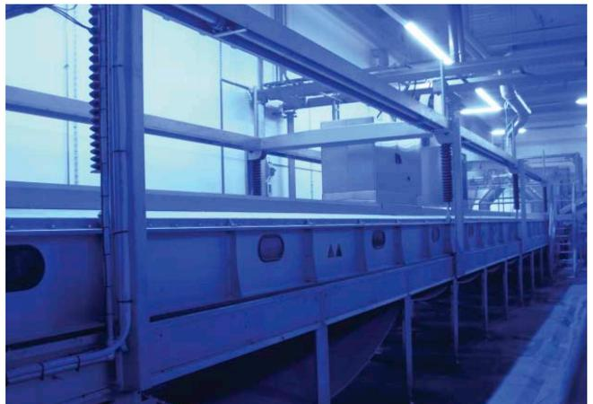
Der Einsatz von Kohlendioxid in mehreren Phasen, wie dies bei unseren CAS Systemen erfolgt, wie zum Beispiel dem geradlinigen CAS SmoothFlow System, wird explizit auf der Liste von Betäubungsmethoden genannt, die ohne Erfüllung zusätzlicher Voraussetzungen zugelassen werden. Das modulare CAS System lässt sich optimal mit den Transportsystemen für Lebendgeflügel verbinden.
