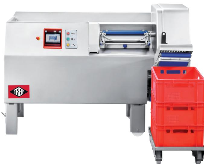
Ausgestattet mit Waage (optional) stoppt der ARGON+ den Schneidvorgang, sobald das vorgegebene Gewicht erreicht ist. Die Abweichung vom Sollgewicht liegt bei maximal +/- 0,3 %.
