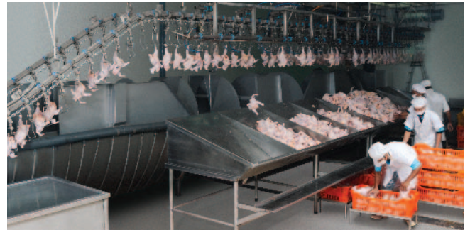
Ligne de distribution dotée de bacs collecteurs pour la sélection des poids
