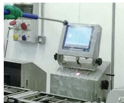
Lavage intensif conformément à la norme IP69K.
