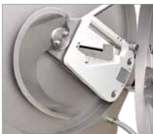
Das Messer arbeitet mit einer Geschwindigkeit von bis zu 300 Umdrehungen/Minute.
