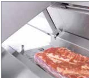
Die horizontale Kammer ermöglicht ein optisch ansprechendes Ablegen des geschnittenen Produktes.
