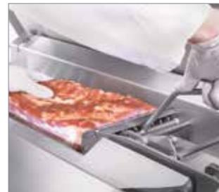
Der Greifer ermöglicht das Greifen von Produktbreiten bis zu 270 mm.
